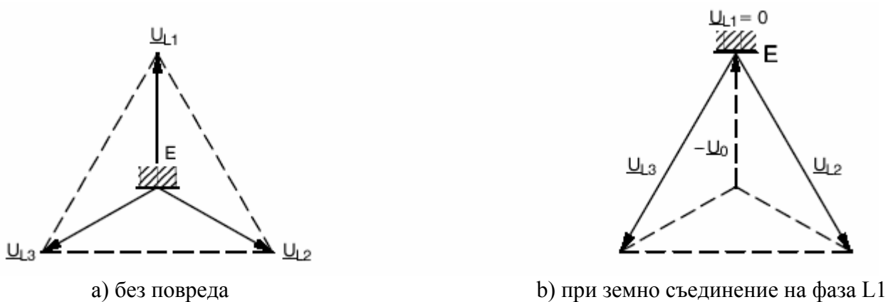
Фиг. 9. Земно съединение при незаземени системи
